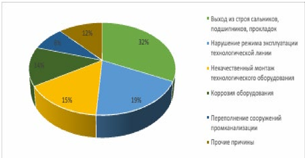
Рисунок 2.3 – Причины возникновения аварий, связанные с технологическим оборудованием, расположенным на открытых производственных площадках
